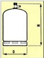
***UTILICE BOMBONAS DE GAS DE 13 KG O 6 KG (BUTANO O PROPANO), DE UNA ALTURA MÁXIMA DE 615 MM Y UN DIÁMETRO EXTERIOR DE 310 MM***
